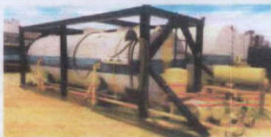
ITEM-27 TANQUE DE AGUA POTAVEL DE 15.000LTS NO SKYD COM UM PULMAO E BOMBA CENTRIFUGA DE 1CV.
